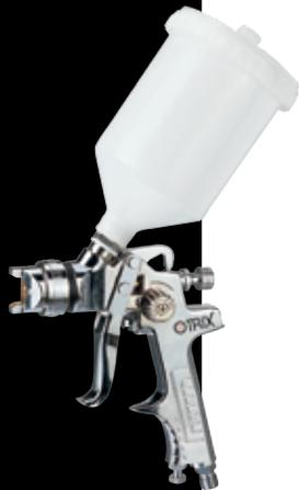
Универсальный окрасочный пистолет системы HVLP с верхним бачком. Применяется для нанесения различных лакокрасочных покрытий, таких как лаки, 2К-акриловые краски, грунты-порозаполнители, антикоррозийные грунты и т.д. Может применяться для нанесения красок на водной основе. Распыляющая головка изготовлена из латуни, что обеспечивает ее высокую износостойкость. Дюза, игла и корпус сделаны из нержавеющей стали. Регулировка подачи воздуха находится в нижней части ручки пистолета.
