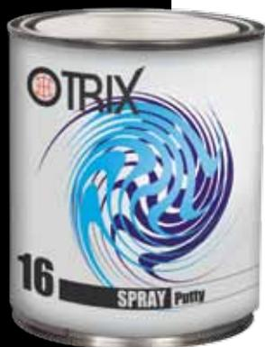
Жидкая шпатлевка предназначена для напыления на больших поверхностях. Может наноситься на голый металл и стекловолокно. Толстый слой и легкость в обработке обеспечит идеальную поверхность. Поставляется в комплекте с отвердителем.
