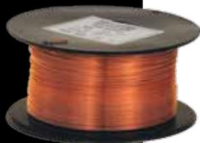
Омедненная проволока применяется для полуавтоматической сварки углеродистых и низко-легированных сталей как в смеси Ag/20 CO<sub>2</sub>, так и в чистом CO<sub>2</sub>. Качественная намотка проволоки на катушку, стабильный калибр по всей длине в сочетании с низким содержанием вредных S и P обеспечивают стабильное горение проволоки с минимальным разбрызгиванием и высокое качество шва. Проволока поставляется на пластмассовых кассетах 1 и 5 кг, намотка рядная.
