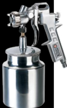
Универсальный окрасочный пистолет конвенциональной системы распыления с нижним бачком. Рекомендуется для нанесения 1К-синтетических эмалей, грунтов, жидких шпатлевок и т.д. Регулировка подачи воздуха отсутствует.
