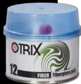
Двухкомпонентная полиэфирная выравнивающая шпатлевка грубой структуры с добавлением стекловолокна. Предназначена для ремонта больших участков, поврежденных коррозией, и ликвидации отверстий (до 1 см<sup>2</sup>) на стальной поверхности. Пластична при нанесении, обладает высокой механической прочностью и великолепной адгезией к голому металлу. Хорошо подходит для частей кузова с ослабленной несущей функцией благодаря наличию в ней отрезков стекловолокна. Выпускается в комплекте с отвердителем.
