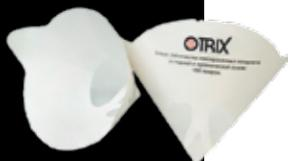
Фильтр сетчатый бумажный. Одноразовая бумажная воронка с фильтрующей нейлоновой вставкой для любых типов красок. Изготовлен с помощью специального клея нейтрального к ЛКМ. Фильтрующий элемент из нейлона с ячейками 190 мкм обеспечивает превосходную проходимость материала, задерживая при этом все посторонние частицы, различные включения и сгустки.
